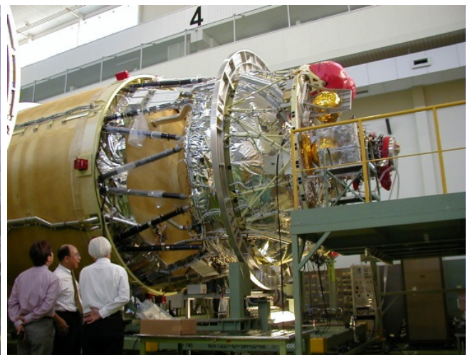
図45: H-2Aロケット2段組み立て中
