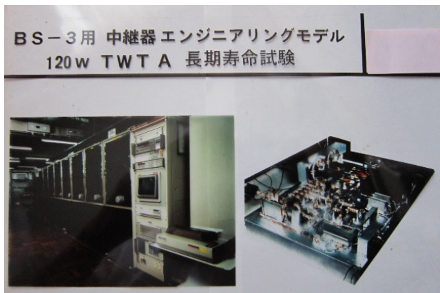
図8:BS-3 中継機EM とTWT寿命試験装置
