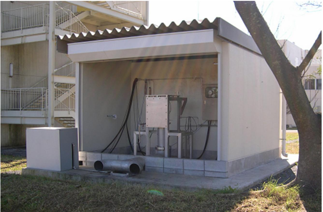
図10 地上燃焼試験施設(エンジンスタンド)
