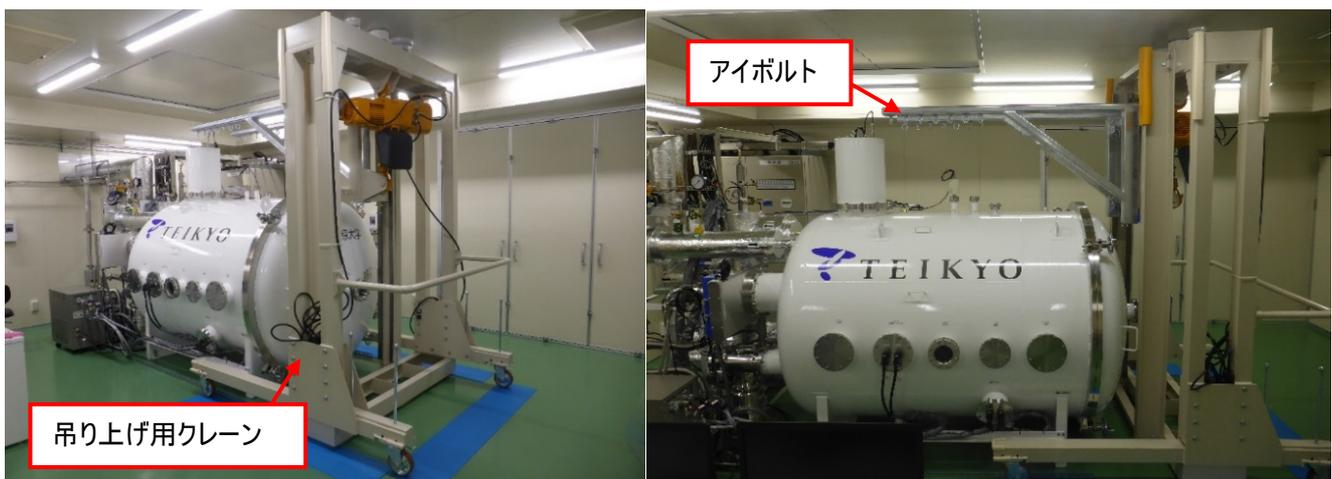
図3 吊り上げ用クレーン
