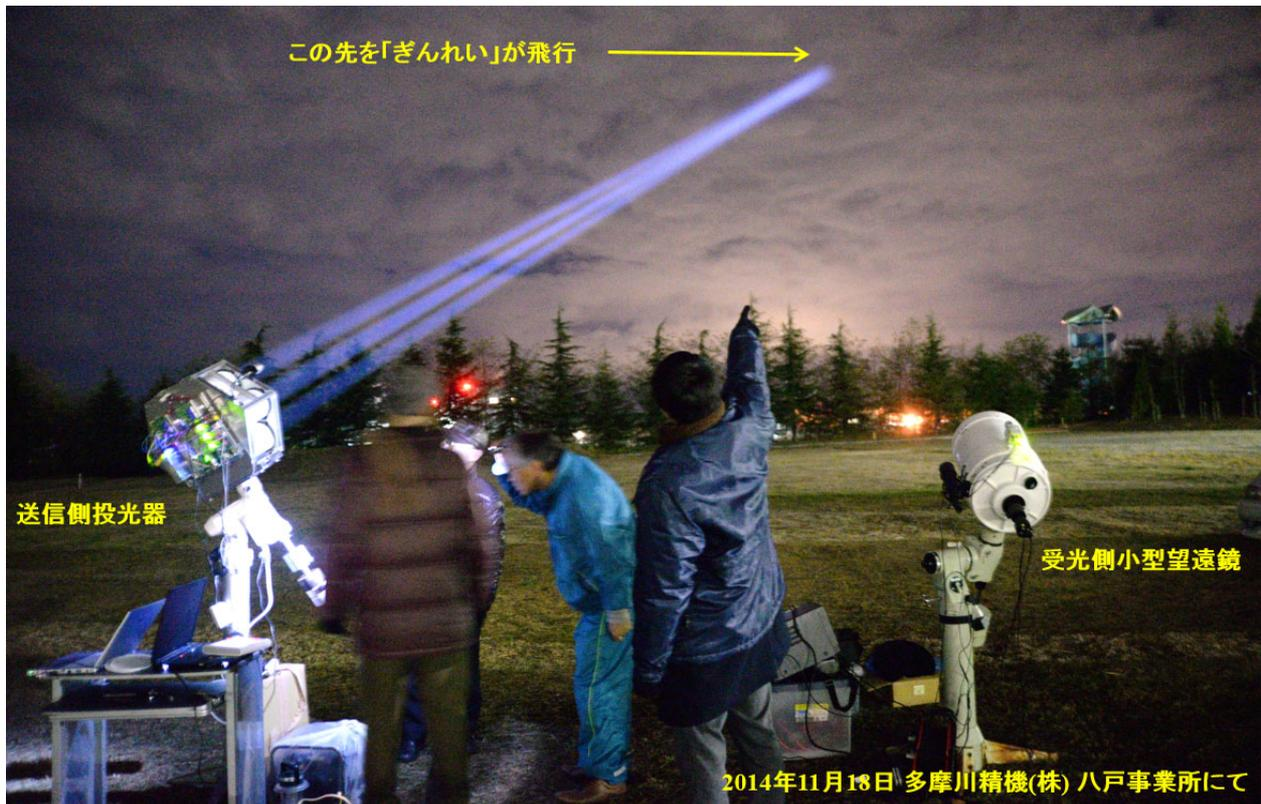
図14 双方向可視光通信実験
