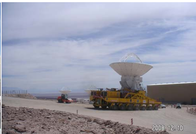
▲組み立て調整が終わり、第一号機として山頂施設へアンテナ運搬専用車で運ばれる日本のアンテナ(2008年12月)
