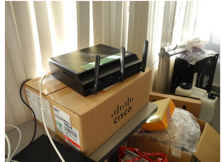
Cisco Systems社 携帯通信対応通信機器 (ルーター)
