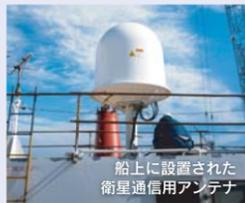
船上に設置された衛星通信アンテナ
