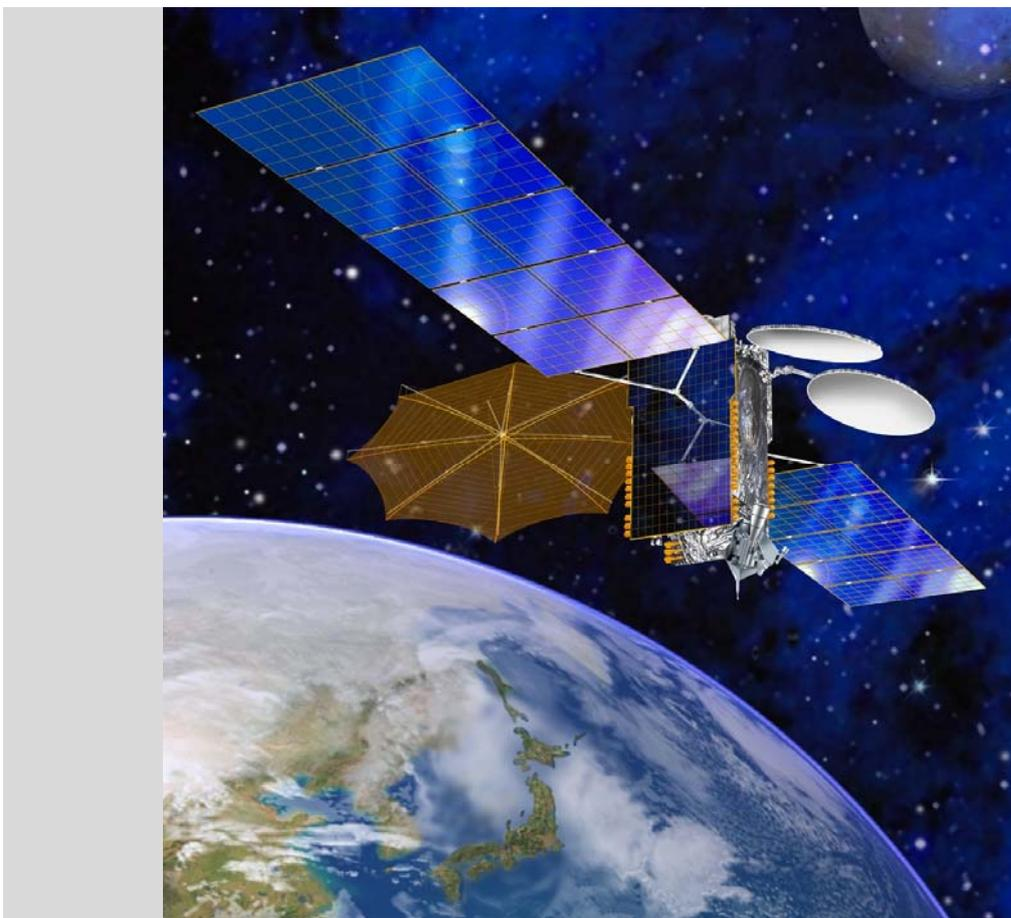
・Fig-2: JCSAT-5A(JCSAT-9)の軌道上イメージ図。傘のように見えるのはメッシュ型のアンテナ。©Lockheed Martin
