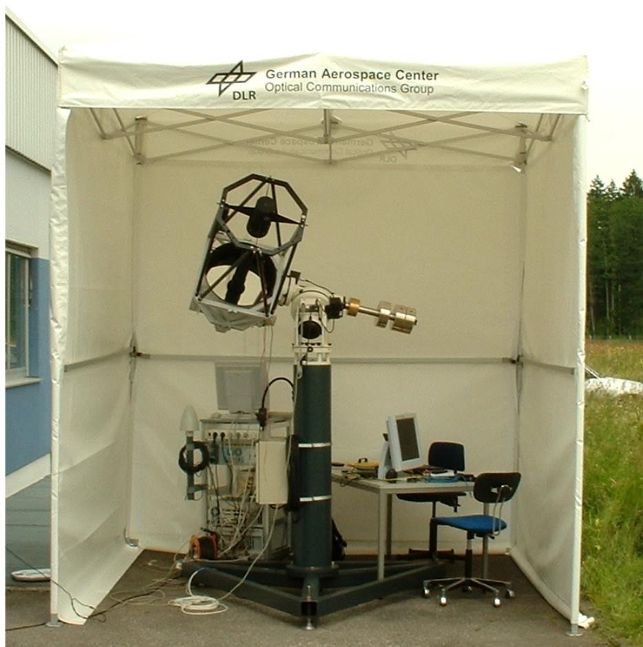
図 3. アンテナ開口直径 40cm の可搬型光地上局<sup>16)</sup>
