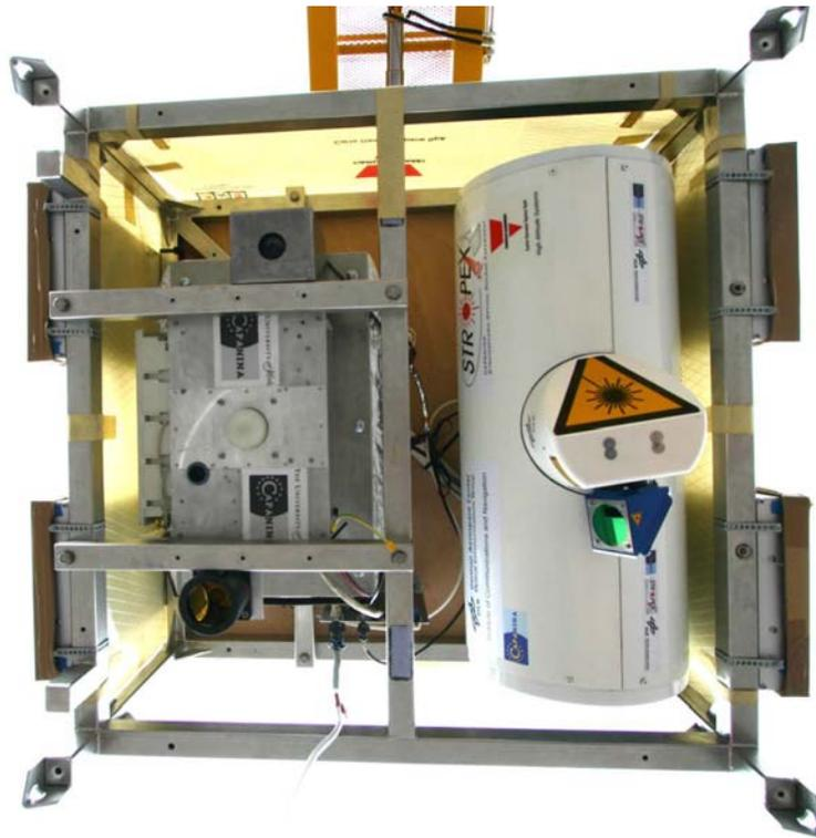
図 4. DLR の成層圏通信自由空間実験レーザーターミナル (FELT)。
