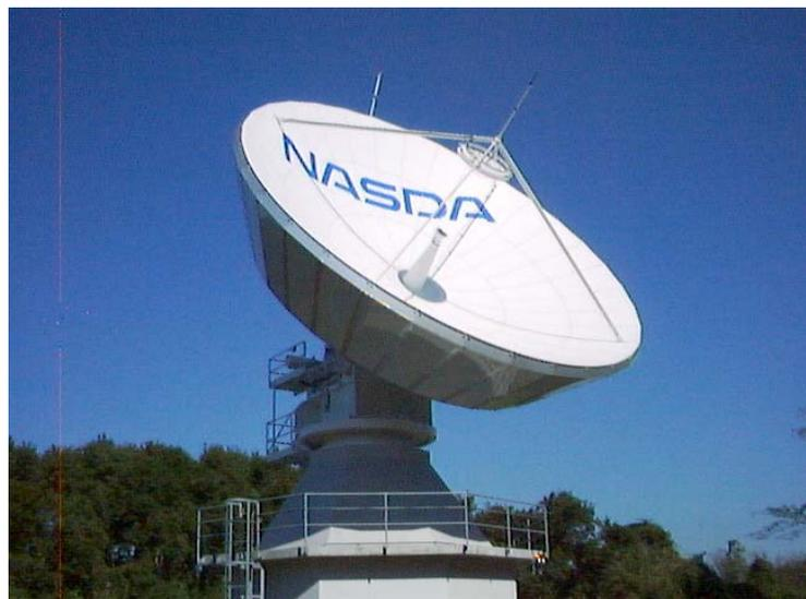
▲ 衛星間通信実験専用の地上局アンテナ
